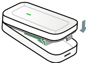
Рисунок 6.5 – Закрытие корпуса датчика
